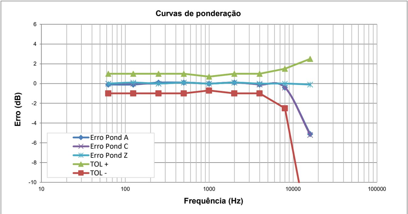
**Teste acústico (normalizado em 1000 Hz)**
