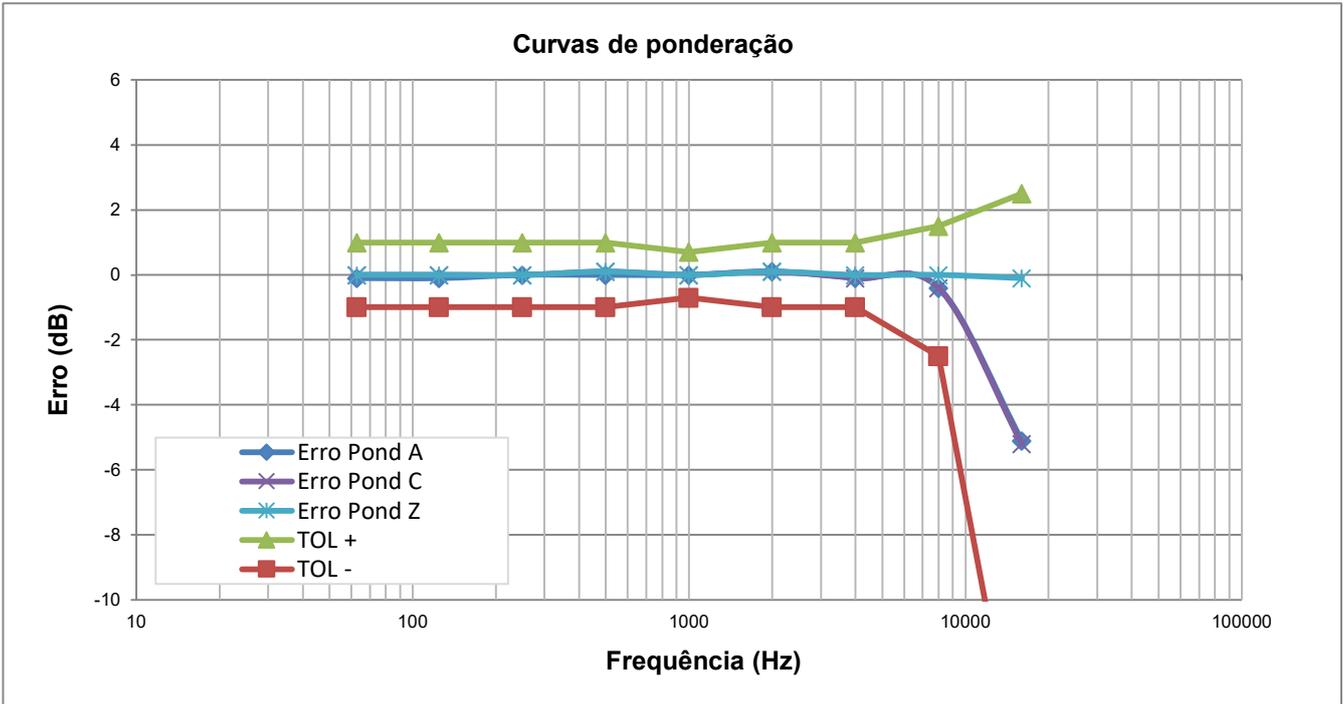
**Teste acústico (normalizado em 1000 Hz)**
