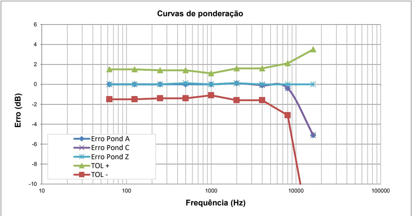
**Teste acústico (normalizado em 1000 Hz)**
