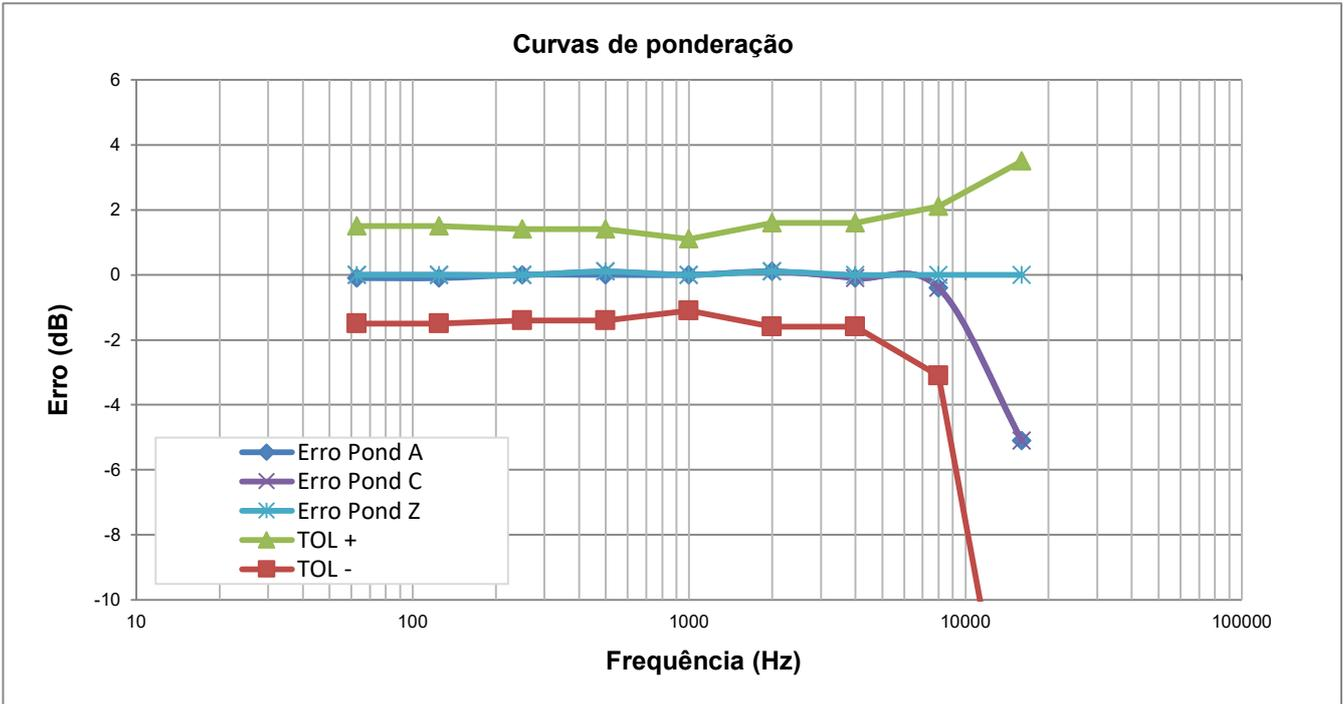
**Teste acústico (normalizado em 1000 Hz)**
