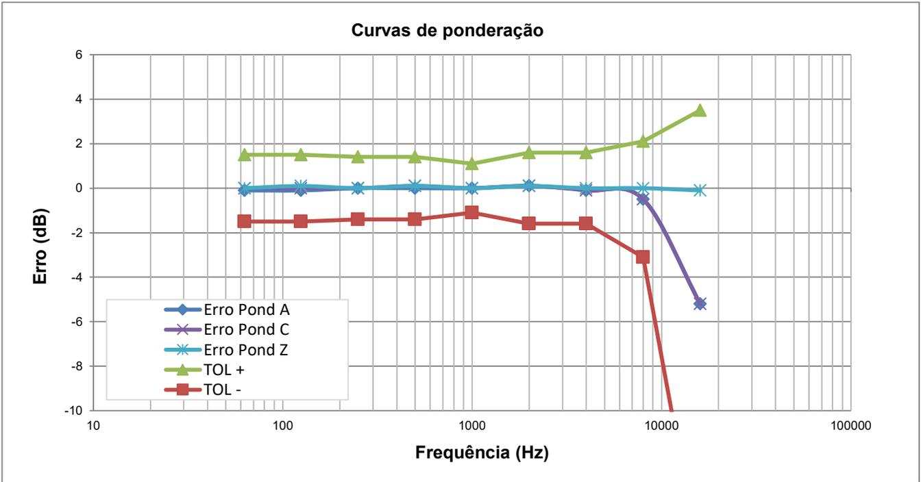
**Teste acústico (normalizado em 1000 Hz)**
