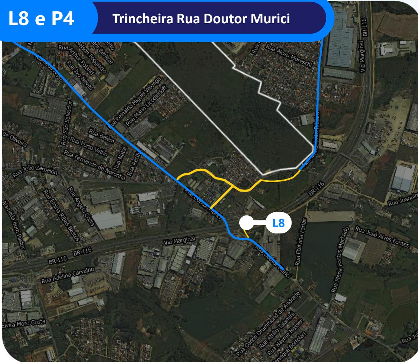
Ampliação e estruturação da trincheira da **Rua Doutor Murici** sob a BR-116 considerando a passagem de no mínimo duas faixas de rolamento em cada um dos sentidos, ciclovia e calçadas, além de dispositivos do tipo rotatória para organizar o tráfego no cruzamento com as marginais da rodovia.
