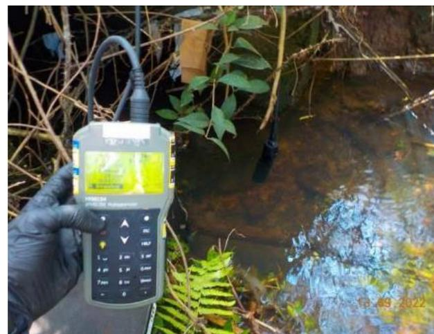
Equipamento utilizado para medições físico-químicas da água
